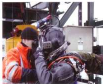
Duiker met helm, ademgas van de oppervlakte en noodlicht.
